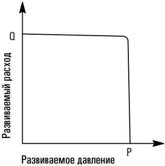
Рабочая характеристика срабатывания регулятора давления при статической температуре 49°C (120°C)
